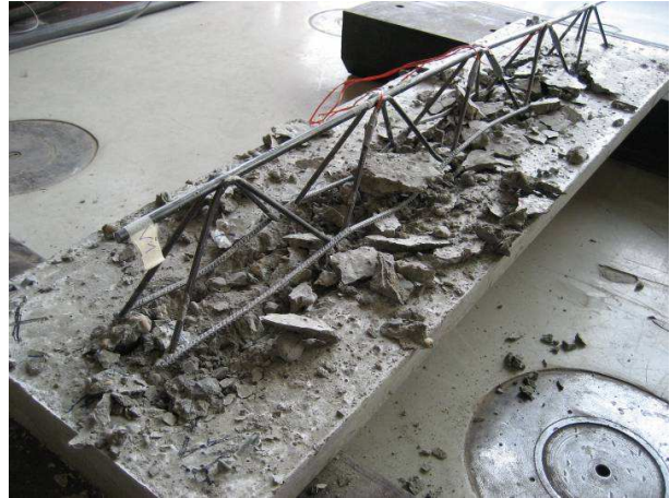
BILD 5 Probekörper nach Ausbau aus dem Versuchsrahmen (duktil versagter Probekörper)
