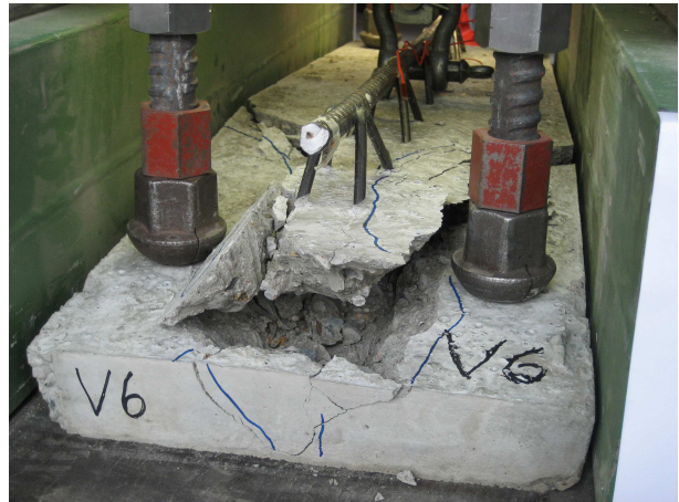
BILD 6 Versagen eines Probekörpers mit steifem Gitterträger (plötzliches Versagen)
