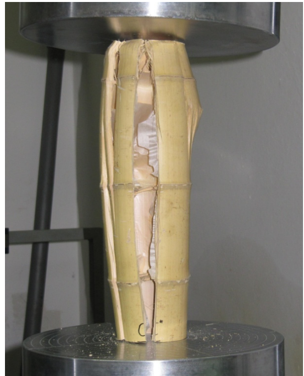
BILD 4 Bambus nach Druckversuch
