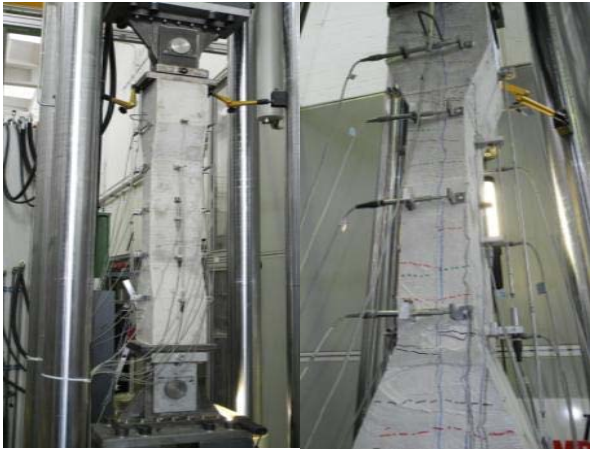
BILD 3: Zugkörper mit eingebautem Lochblech
