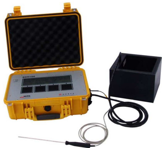
Abb. 1: Entwickeltes Messgerät BSM100 zur zerstörungsfreien Bestimmung des Gehaltes und der Orientierung von Stahlfasern in Frisch- und Festbeton; Quelle: www.hertz.st
