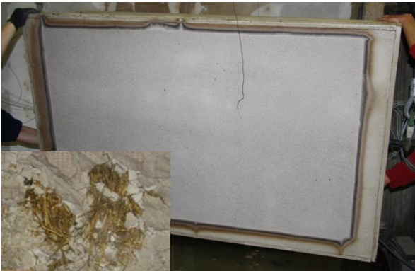
Bild 3 Zustand des Putzes und des Strohs nach dem Brandversuch /1, iBMB/
