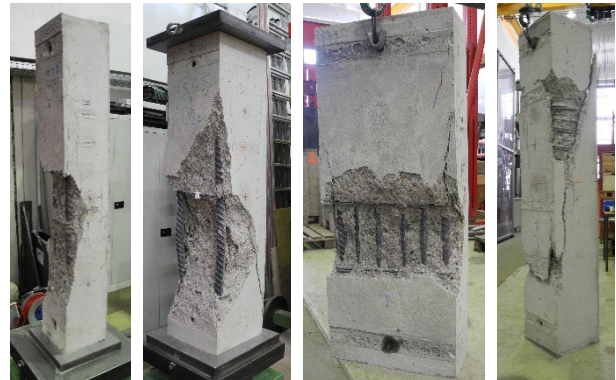
Bild 3: Versuchsgegenstände S 1.1 (links), S 2.3 (Mitte links), S 3.3 (Mitte rechts) und S 4.3 (rechts) nach dem Versuch
