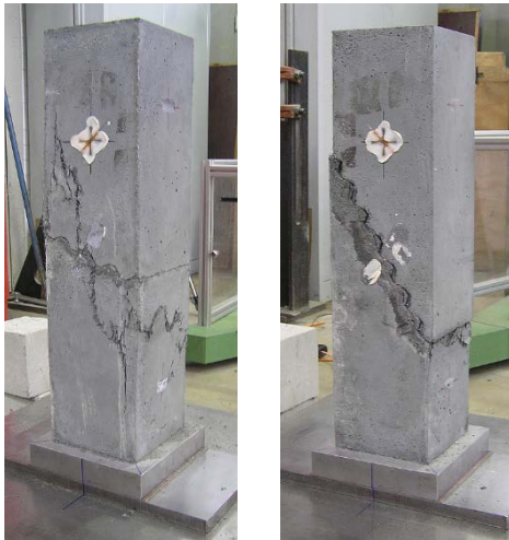
Bild 2: Druckbruch (links) und Gleitbruch (rechts)
