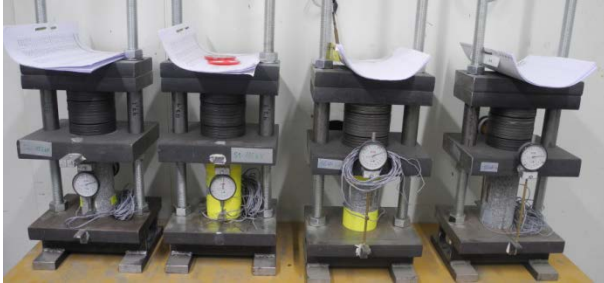
Bild 3: Kriechstände mit UHPSC-Bohrkernen
