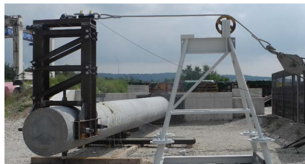
Bild 1: Versuch unter Biege- und Querkraftbeanspruchung (oben) und unter Biege-, Querkraft- und Torsionsbeanspruchung (unten)
