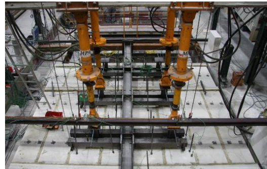
Bild 3 Versuchsaufbau des Großbrandversuchs
