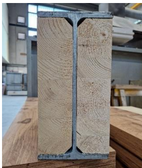
Bild 1: Probekörper aus verzinktem Stahl und Fichte
